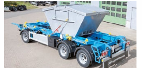
Ein Behälter im Lastschwerpunkt.
