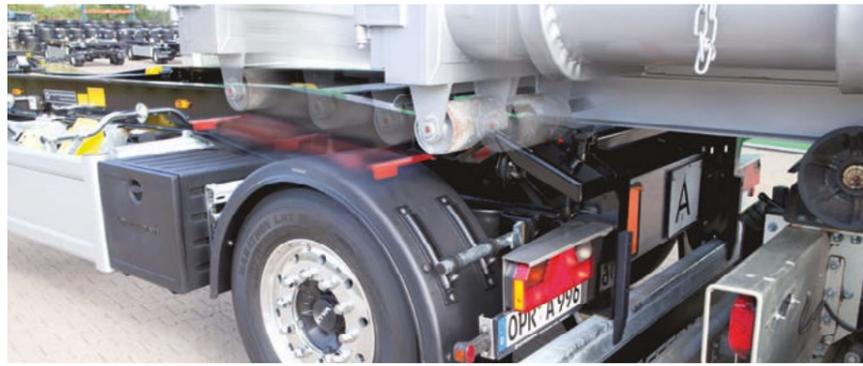
Schlitten in einer geneigten Lage positioniert liegt um den Behälterübersetzworgang zu vereinfachen.
