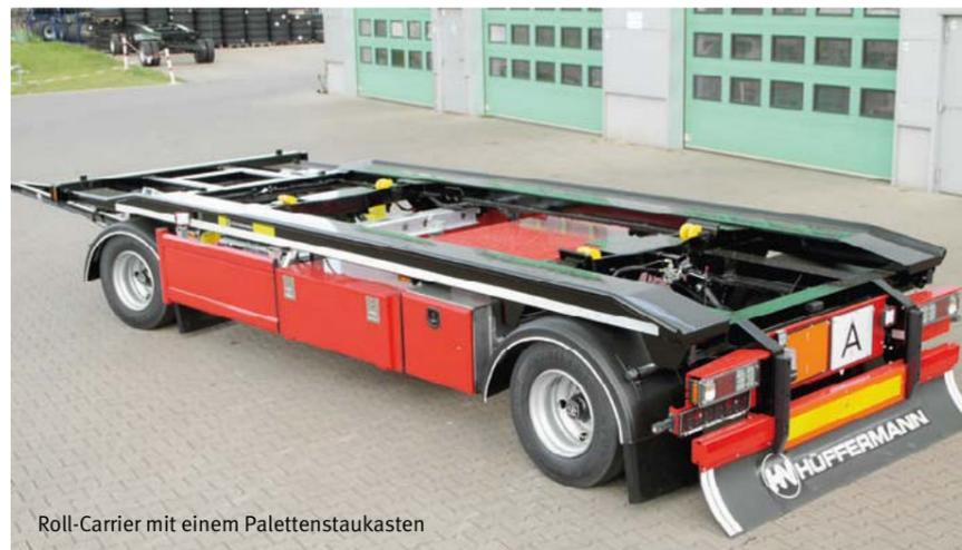
Roll-Carrier mit einem Palettenstaukasten
