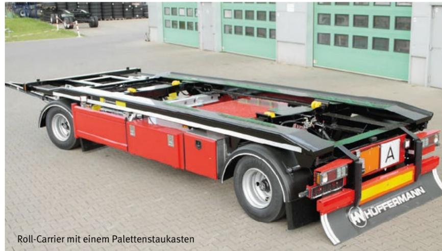
Roll-Carrier mit einem Palettenstaukasten
