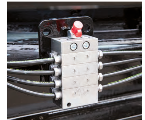
Schmierverteiler an geeigneter Stelle versorgen über einen zentralen Schmier-nippel auch schwer zugängliche Schmierungsstellen, z.B. am Drehgestell.
