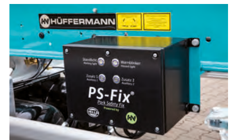
Die Druckschalter sind mit einer Lichtquelle beleuchtet
