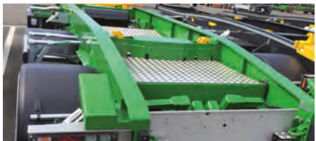
Alu Fahrwerksabdeckung am Schlitten-Carrier
