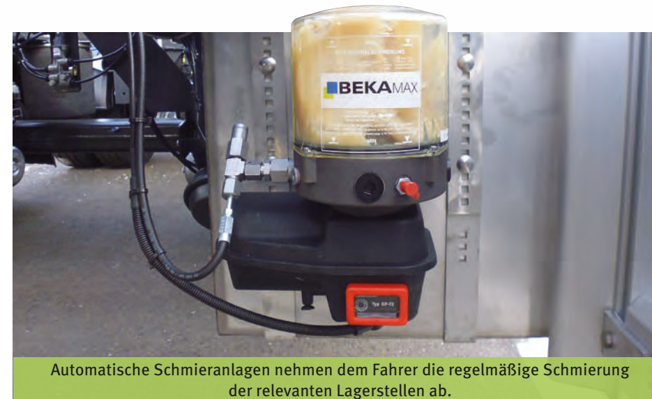
Schmierverteiler an geeigneter Stelle versorgen über einen zentralen Schmier-nippel auch schwer zugängliche Schmierungsstellen, z.B. am Drehgestell.
