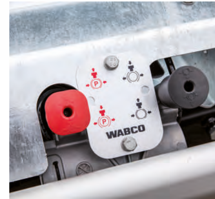
Bedieneinheit am Anhänger, montiert an verzinktem Halter in Fahrtrichtung links.
